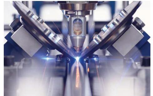
Typische Anwendung von Lasern: Schweißen eines Rohres mit kontinuierlicher Naht. Foto: Trumpf
